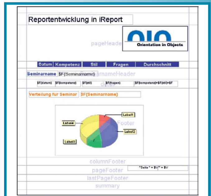
Abb. 2: Reportentwicklung in iReport, Pentaho Report Designer und Crystal Reports for Eclipse (im Bild iReport 1.2.7) – Der Bericht ist in Bänder aufgeteilt, die bestimmen, wann und wie oft die darin enthaltenen Elemente ausgegeben werden. Daten werden im Detail-Band ausgegeben
