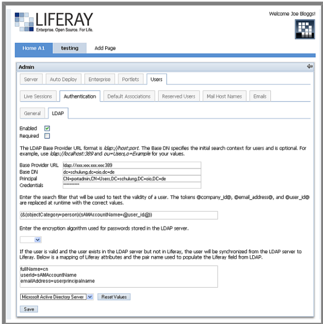
Abbildung 1: Administrative Portlet Anwendung zur Anbindung von Liferay an das LDAP oder Active Directory
