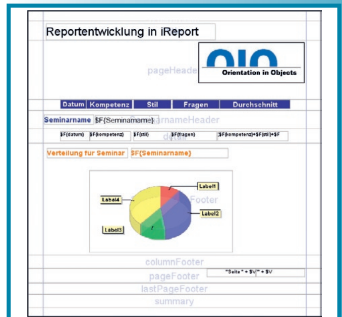
Abb. 2: Reportentwicklung in iReport, Pentaho Report Designer und Crystal Reports for Eclipse (im Bild iReport 1.2.7) – Der Bericht ist in Bänder aufgeteilt, die bestimmen, wann und wie oft die darin enthaltenen Elemente ausgegeben werden. Daten werden im Detail-Band ausgegeben
